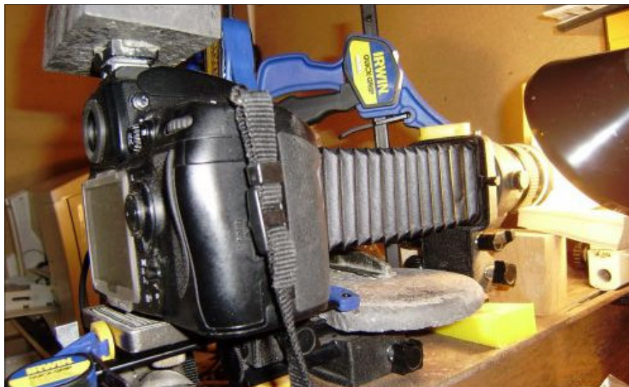
Figur 3. Opstilling af kamera med bælg på jernbjælke. Blylod monteret i blitz-foden. Foto M. Hansen
